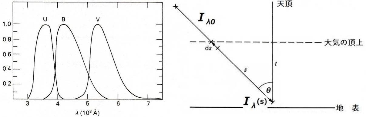
図 1.4 (左) UBВ 等級を測定するため検出器の感度曲線 (Johnson 1965 年より)
