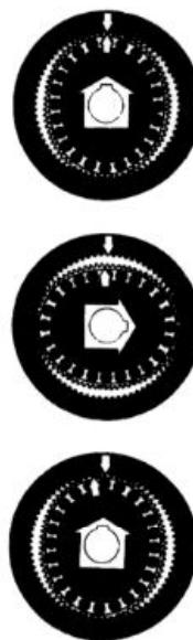
図3 ハーモニックドライブの原理
